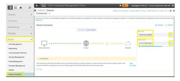
5단계. Cisco Intersight를 시작하고 Admin > Targets > Claim a New Target > Cisco UCS Server (Standalone) > Start. 다음을 입력합니다. Device ID 및 Claim Code CIMC GUI에서 복사한 다음 Claim.
