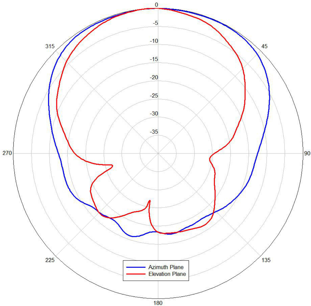
図 1 水平面および垂直面内放射パターン-2.4 GHz 帯域
