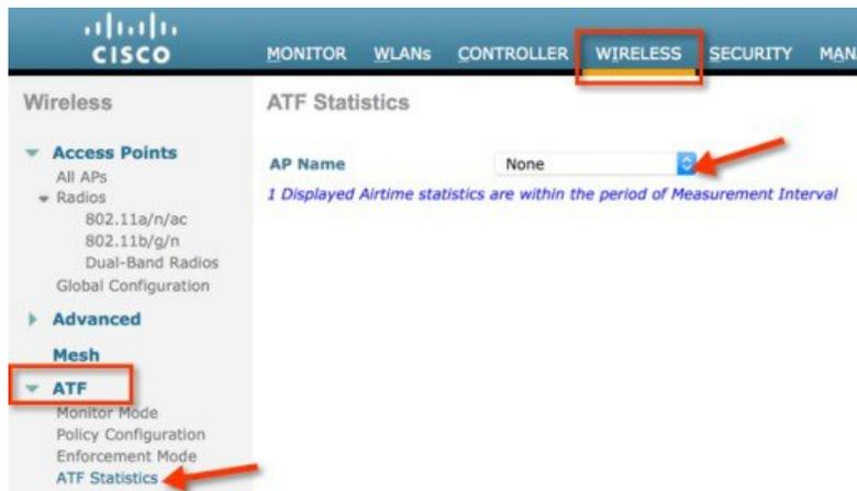
ATF 統計情報ページが、ユーザが WLAN 統計を有効にしたすべての ATF を確認できる場所に表示されます。
