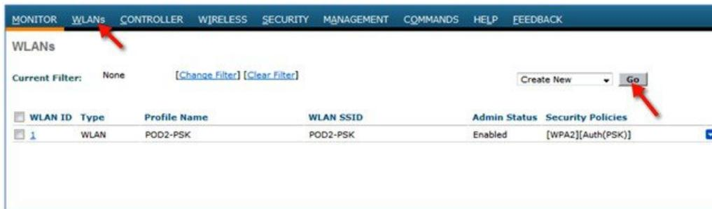
ステップ3 命名規則を使用して POD4-EoGRE などの WLAN を作成し、[Apply] をクリックします。
