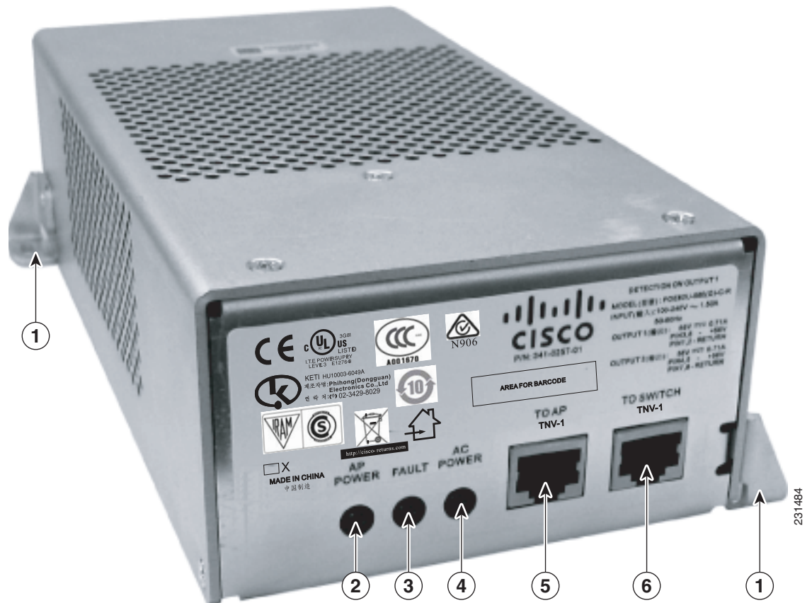
図3 パワーインジェクタのコネクタとLED
