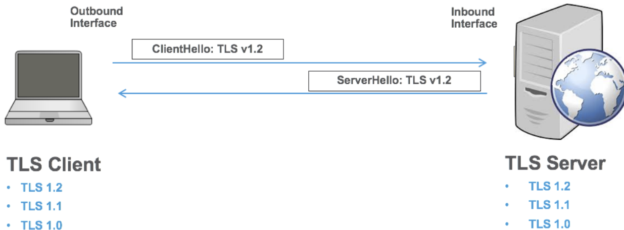
図 3: TLS クライアントとサーバーが TLS 1.2 およびそれ以前の TLS バージョンをサポートしている場合にネゴシエートされる TLS 1.2
