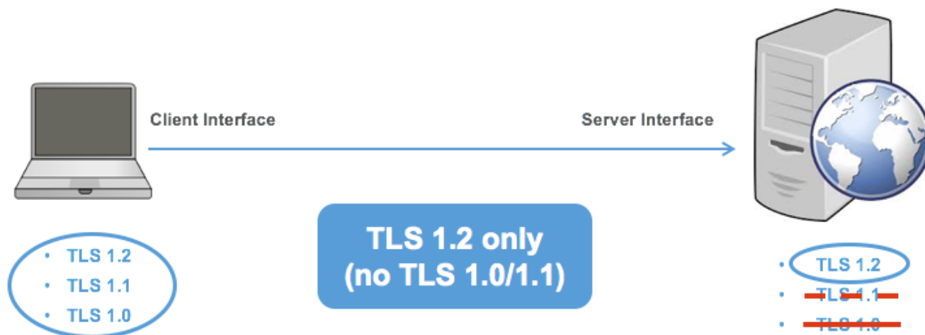
図 4 : TLS 1.0/1.1 を無効にするための設定 (サーバーインターフェイスに適用)
