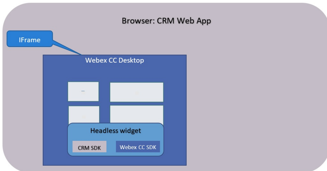
図 9: CRM コネクタ組み込みデスクトップコネクタ アーキテクチャ
