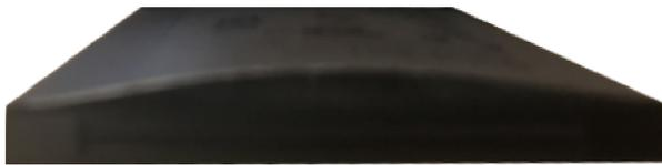
次の画像は、バッテリー収納部に入った状態の膨張したバッテリーです。バッテリーが収納部の壁面との境界でぴったり重なっていないように注意してください。
