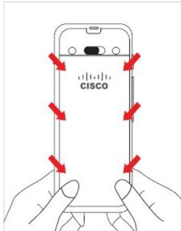
**注意** カバーを無理に押し込まないでください。カバーが無理なくカチッと閉まらない場合、カバーを取り外してバッテリーが正しく挿入されているかどうか確認します。
