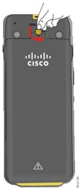
**注意** バッテリー収納部の蓋のネジをゆるめたり、電話機から蓋を取り外したりするときに、先の尖ったものを使わないでください。
