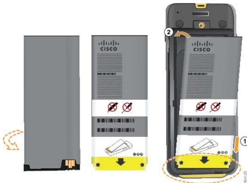
バッテリーの金属接点をバッテリー コンパートメントの接点に接続する必要があります。バッテリーの下部には矢印が表示されており、上部には Cisco のロゴが表示されています。
