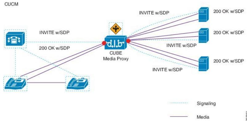
次の例は、CUBE Media Proxy を使用したマルチフォーク録音のネットワークベースの録音を示しています。
