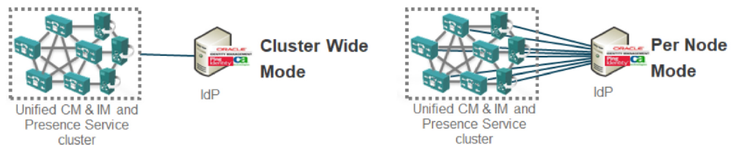
図 2: Cisco Unified Communications Manager の 2 種類の SAML メタデータ契約
