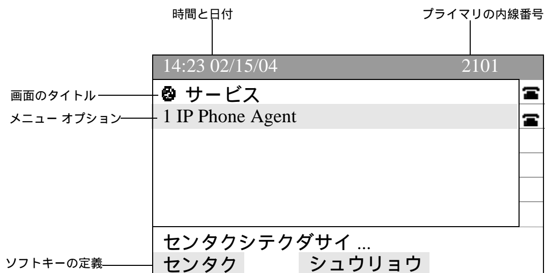
図 1 IP Phone Agent の開始メニュー (表示されるメニューは異なる場合があります)
