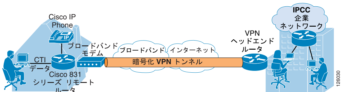
図 2-12 Business Ready Teleworker Solution を介して配置された IP Phone を使用するリモート エージェント
