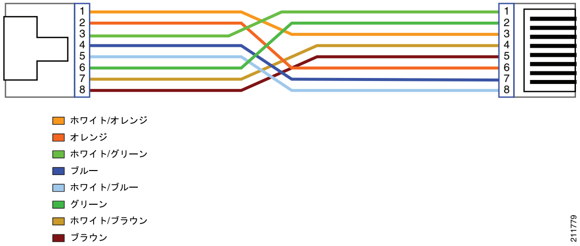
図 B-5 RJ-45 クロス ケーブルのピン割り当てと配線
