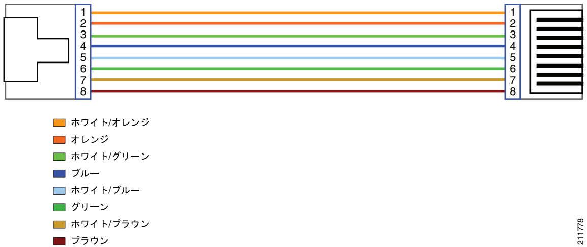
図 B-4 RJ-45 ストレート ケーブルのピン割り当てと配線
