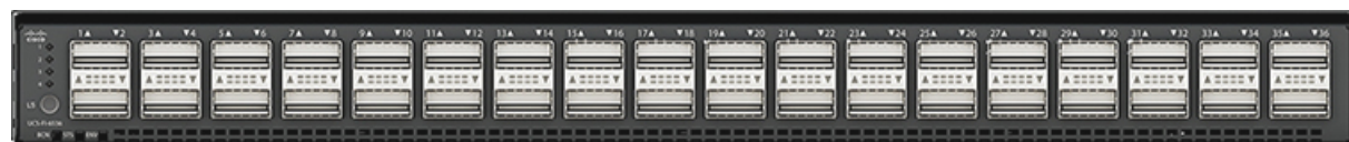
図 6: Cisco UCS 6536 ファブリック インターコネクットの背面図
