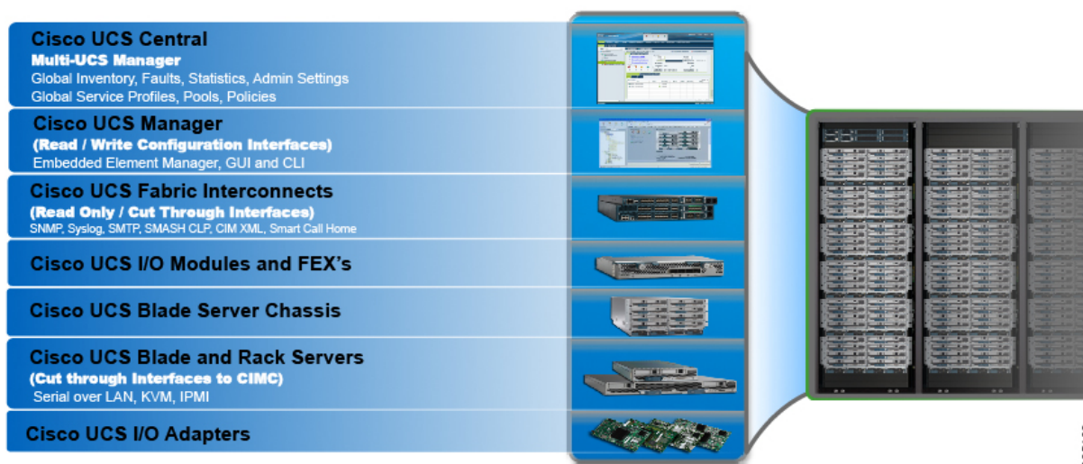
図 2 : Cisco UCS のビルディング ブロックと接続
