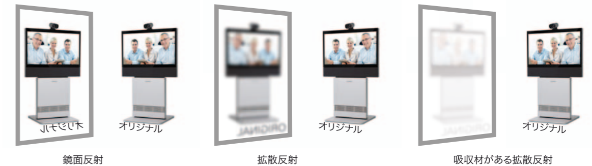
上図：壁から反射する音声は、光の反射と非常に似ています。左に示す鏡面反射は、通常の鏡で見られる反射に似ていますが、中央に示す拡散反射はぼやけた鏡の場合に似ています。吸収材があると拡散反射は、右に示す、ぼやけた「不鮮明な」反射になります。
