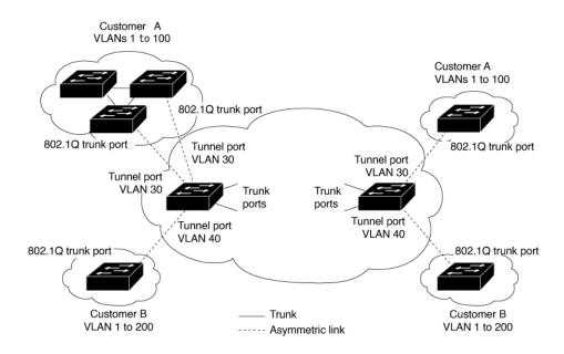
図は、顧客 A と顧客 B がサービス プロバイダー ネットワークの別サイドにおいて複数サイトで同じ VLAN を使用するトポロジを示しています。サービス プロバイダー バックボーン経由でパケットを伝送できるように、顧客 VLAN ID をサービスプロバイダー VLAN ID にマッピングします。サービス プロバイダー バックボーンの反対側で、そちら側の顧客拠点で使用するために元の顧客 VLAN ID に戻されます。サービス プロバイダー ネットワークのそれぞれの側の顧客接続ポートで同じ VLAN マッピング セットを設定します。
