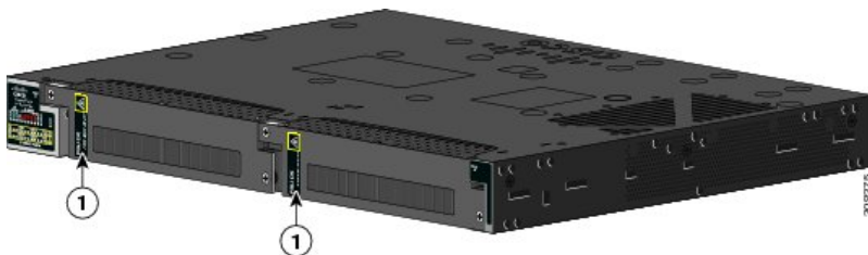
図 7: 電源モジュールの挿入
