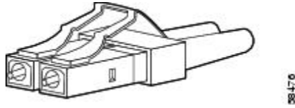
図 36: 光ファイバ SFP モジュールの LC コネクタ
