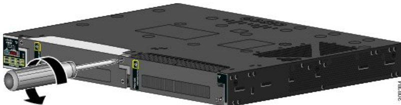
図 31: ネジの取り外し
