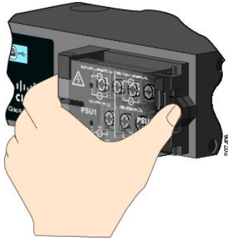
図 26: 電源入力端子カバーのオープン
