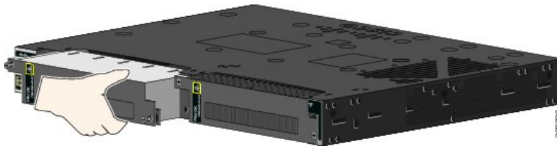
図 24: 電源ブランクの取り外し
