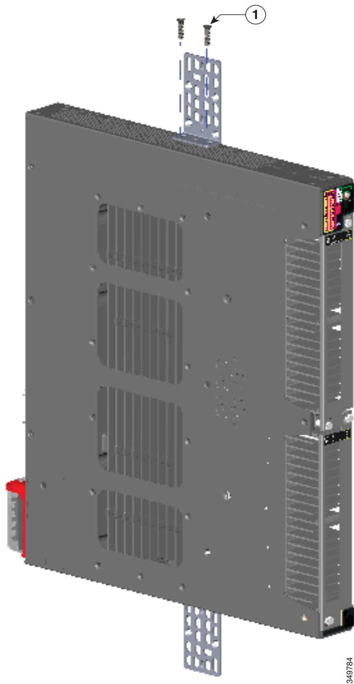
図 9 19 インチ ラック用の取り付け
