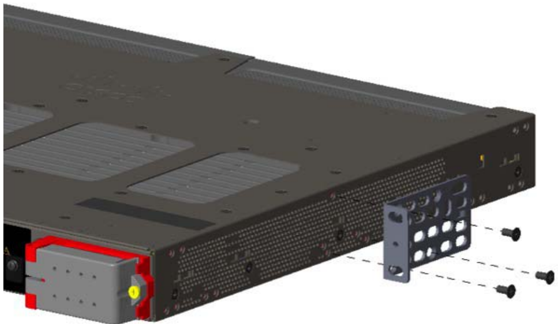
図 2 19 インチ ラック用ブラケットの取り付け(中間取り付け)
