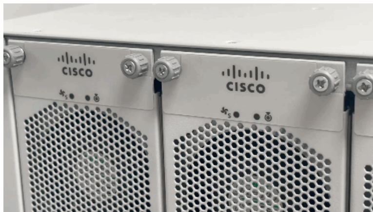
図 14: ファントレイの非脱落型ネジの取り外し
