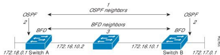
図 1: OSPFで構成されたネットワーク上の BFD プロセス
