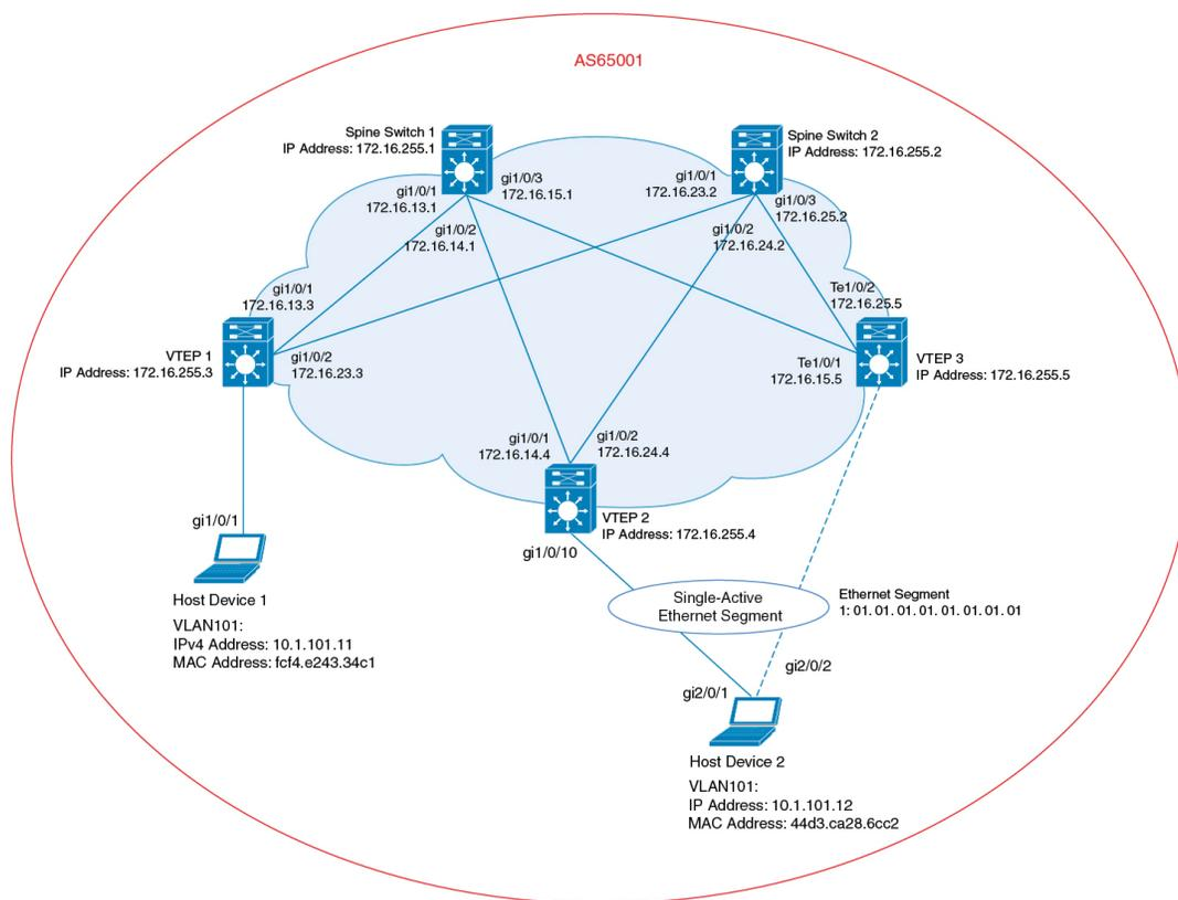
このトポロジは、2台のスパインスイッチ（スパインスイッチ1およびスパインスイッチ2）と3台のVTEP（VTEP1、VTEP2およびVTEP3）を備えたEVPN VXLANネットワークを示しています。ホストデバイス1はVTEP1に接続されています。ホストデバイス2は、イーサネットセグメント1を通過するデュアルホーム接続のシングルアクティブ接続としてVTEP2およびVTEP3に接続されます。
