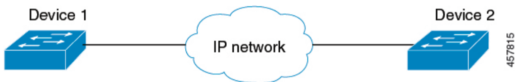
図3: Generalized PTP over Layer 3ユニキャスト
