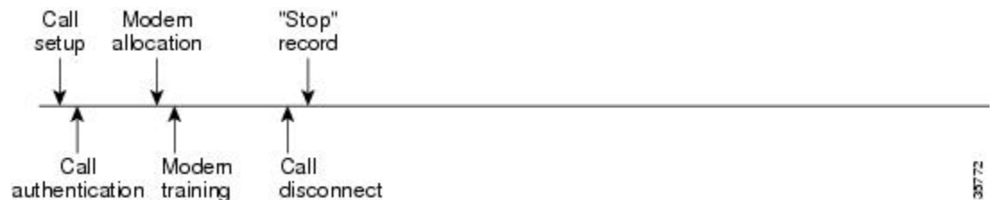
図 3: ユーザー認証前にコールの接続解除が発生し、AAA リソース失敗終了アカウントिंगを有効にしたモデムダイヤルインコール設定シーケンス
