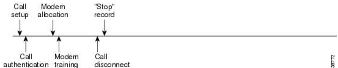
図 6: ユーザー認証前にコールの接続解除が発生し、AAA リソース失敗終了アカウントングを有効にしたモデム ダイヤルインコール設定シーケンス
