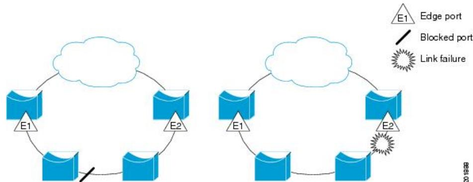
上の図に示されたセグメントは、オープンセグメントで、2つのエッジポート間は接続されていません。REP セグメントはブリッジンググループの原因とならないため、セグメントエッジを安全に任意のネットワークに接続できます。セグメント内のスイッチに接続されているすべてのホストには、エッジポートを通じて残りのネットワークに接続する方法が2つありますが、いつでもアクセス可能なのは1つだけです。いずれかのセグメントまたは REP セグメントのいずれかのポートに障害が発生した場合、REP はすべての ALT ポートのブロックを解除し、他のゲートウェイ経路で接続できるようにします。
