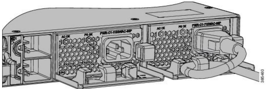
**ステップ7** 電源コードを電源モジュールに接続してから AC 電源コンセントに接続します。元電源側の電源を投入します。
