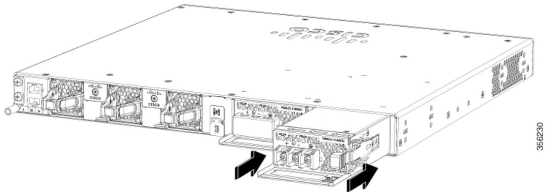
**ステップ6** DC 入力電源の配線 (14 ページ) の説明に従い、入力電源を接続します。
