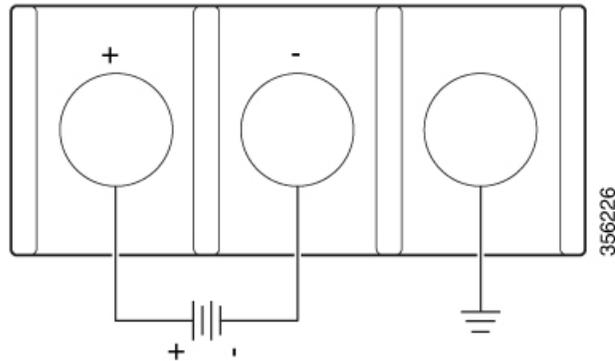
**ステップ 4** すべての端子ブロックのネジを 11 lbf-in のトルクで締めます。
