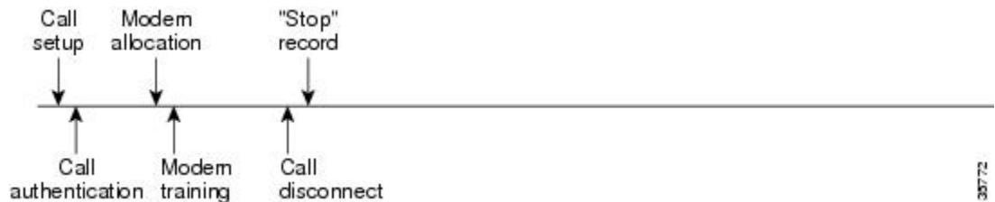
図 3: ユーザ認証前にコールの接続解除が発生し、AAA リソース失敗終了アカウントिंगを有効にしたモデムダイヤルインコール設定シーケンス
