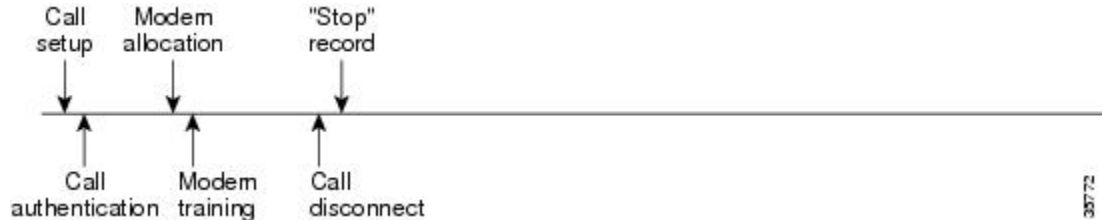
図 6: ユーザ認証前にコールの接続解除が発生し、AAA リソース失敗終了アカウントングを有効にしたモデムダイヤルインコール設定シーケンス
