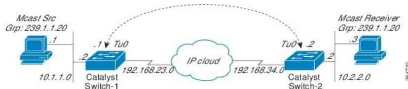
上の図では、マルチキャスト送信元 (10.1.1.1) は、Catalyst スイッチ 1 に接続され、マルチキャストグループ 239.1.1.20 に設定されています。マルチキャスト受信者 (10.2.2.3) は、Catalyst スイッチ 2 に接続され、グループ 239.1.1.20 のマルチキャストパケットを受信するように設定されています。スイッチ 1 とスイッチ 2 は、マルチキャストルーティング用に設定されていない IP クラウドで分離されています。
