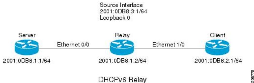
リレーはクライアントから要求を受信すると、クライアント方向インターフェイス（イーサネット 1/0）のアドレスを `relay-forward` メッセージの `link-address` フィールドに含めます。このアドレスは、サーバによってアドレスプールの選択に使用されます。その後、リレーは `relay-forward` メッセージをサーバに送信します。デフォルトでは、サーバ方向（イーサネット 0/0）インターフェイスのアドレスが IPv6 送信元として使用され、サーバはそのアドレスに回答を送信します。
