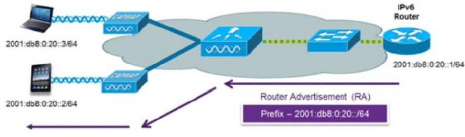
Cisco 対応 IPv6 ルータからの次の Cisco IOS コンフィギュレーション コマンドを使用して、SLAAC のアドレッシングとルータ アドバタイズメントをイネーブルにします。
