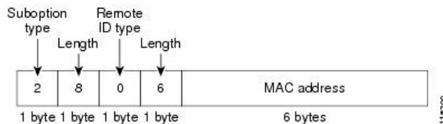
図「ユーザ設定のサブオプションの packets 形式」は、ユーザ設定のリモート ID サブオプション、および回線 ID サブオプションの packets 形式を示しています。スイッチでは、DHCP スヌーピングをグローバルにイネーブルにし、`ip dhcp snooping information option format remote-id` グローバル コンフィギュレーション コマンド、および `ip dhcp snooping vlan information option format-type circuit-id string` インターフェイス コンフィギュレーション コマンドを入力した場合に、これらの packets 形式が使用されます。
