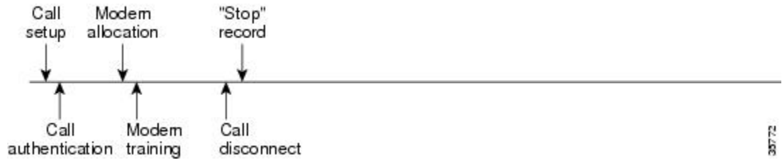
図 3: ユーザ認証前にコールの接続解除が発生し、AAA リソース失敗終了アカウンティングを有効にしたモデムダイヤルインコール設定シーケンス
