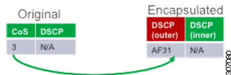
図 3: レイヤ2 フレームから VXLAN 外部ヘッダーへの優先順位のコピー
