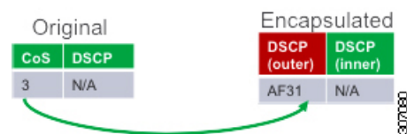
図 27: レイヤ 2 フレームから VXLAN 外部ヘッダーへの優先順位のコピー
