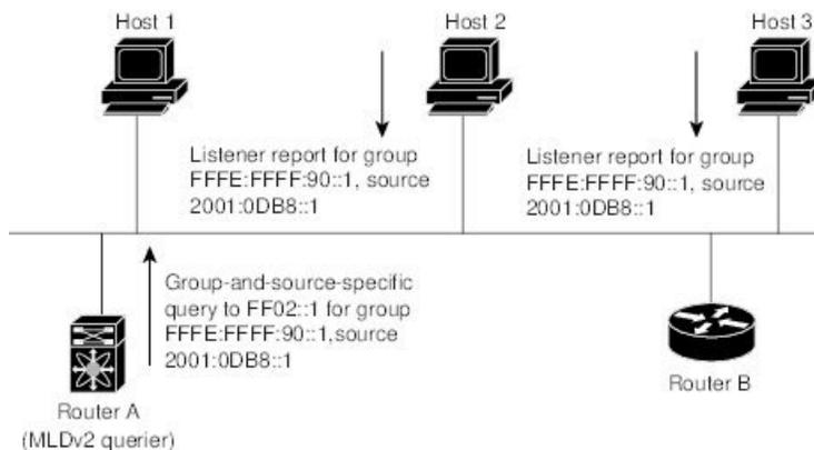
IP アドレスが最下位のルータが、サブネットの MLD クエリアとして選出されます。ルータは、自身よりも下位の IP アドレスを持つルータからクエリー メッセージを継続的に受信している間、非クエリアとして動作し、クエリアタイムアウト値をカウントするタイマーをリセットします。ルータのクエリアタイマーが期限切れになると、そのルータは代表クエリアになります。そのあとで、このルータが、自身よりも下位の IP アドレスを持つルータからのホストクエリーメッセージを受信すると、ルータは代表クエリアとしての役割をドロップしてクエリアタイマーを再度設定します。
