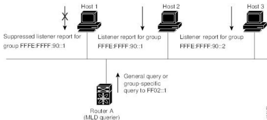
ホスト 1、2、および 3 は要求外の MLD リスナー レポート メッセージを送信して、グループまたはチャンネルに関するマルチキャスト データの受信を開始します。ルータ A (サブネットの代表 MLD クエリア) は、リンクスコープの全ノードを対象として、マルチキャスト アドレス FF02::1 に定期的に共通のクエリ メッセージを送信し、マルチキャスト グループに対する各ホストの受信要求を検出します。グループ固有のクエリーは、特定のグループの情報を要求するホストを検出する場合に使用されます。グループ メンバーシップ タイムアウト値を設定でき
