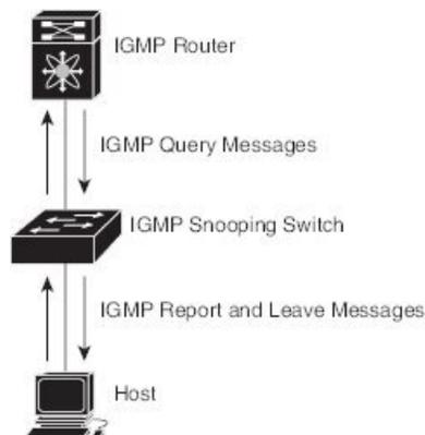
IGMP スヌーピング ソフトウェアは、IGMPv1、IGMPv2、およびIGMPv3 コントロールプレーンパケットの処理に参与し、レイヤ 3 コントロールプレーンパケットを代行受信して、レイヤ 2 の転送処理を操作します。
