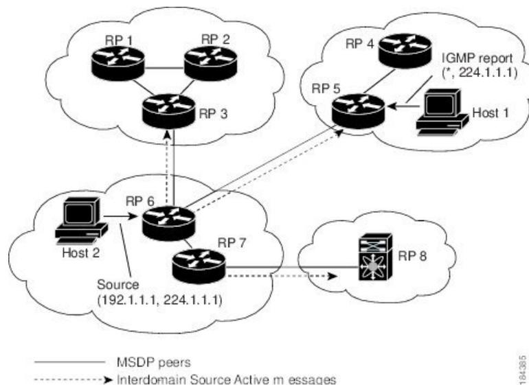
各 RP 間で MSDP ピアリング設定を行うには、フルメッシュを作成します。一般的な MSDP フルメッシュは、RP 1、RP 2、RP 3 のように自律システム内に作成され、自律システム間には作成されません。ループ抑制および MSDP ピア逆パス転送 (RPF) により、SA メッセージのループを防止するには、BGP を使用します。
