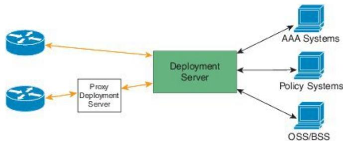
PnP サーバは、スマートフォンと PC の展開アプリケーションなどのプロキシサーバ、Neighbor Assisted Provisioning Protocol (NAPP) として動作する他の PnP エージェント、および VPN ゲートウェイのようなその他のタイプのプロキシ展開サーバとも通信します。
