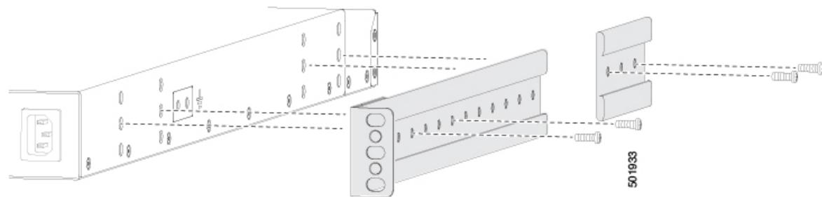
c) 4本のM4ネジを使用して前面マウント ブラケットと背面マウント ブラケットをシャーシに固定し、12インチポンド（1.36 N·m）のトルクで各ネジを締めます。
