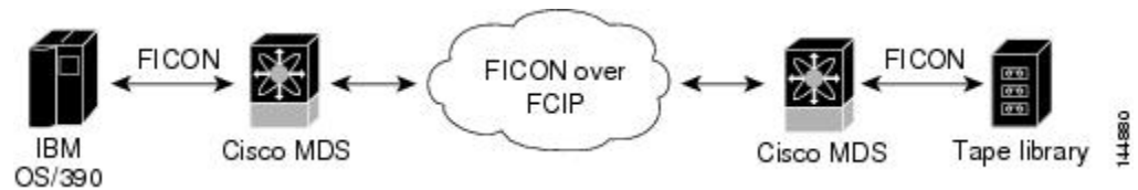
図 6: スタンドアロン IBM-Virtual Tape Server (VTS) /STK-Virtual Shared Memory (VSM) にアクセスするホスト
