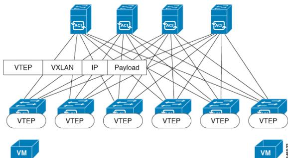
VXLAN は VTEP デバイスを使用してテナントのエンドデバイスを VXLAN セグメントにマッピングし、VXLAN のカプセル化およびカプセル化解除を実行します。各 VTEP 機能には、次の 2 つのインターフェイスがあります。
