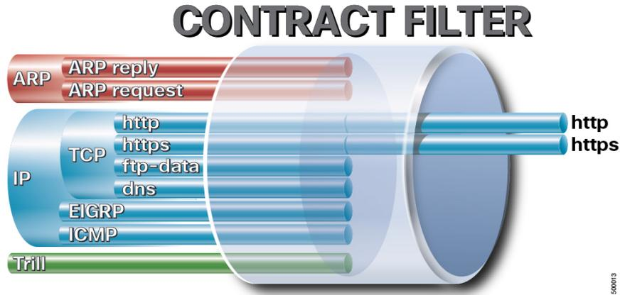
次の図は、コントラクトが EPG の通信をどのように管理するかを示します。
