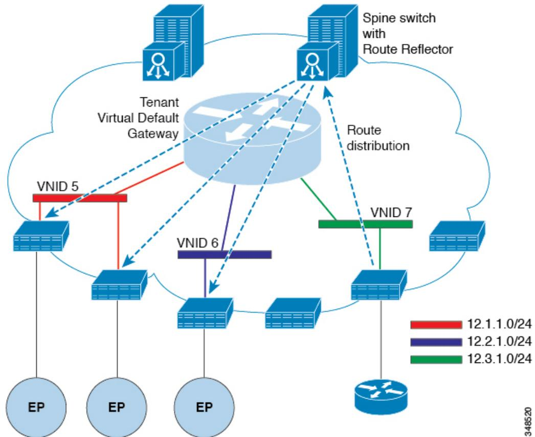
ピアリングによって学習されるルートは、スパインスイッチに送信されます。スパインスイッチはルートリフレクタとして動作し、外部ルータを同じテナントに属するインターフェイスを持つすべてのリーフスイッチに配布します。これらのルートは、最長プレフィクス照合(LPM)により集約されたアドレスで、外部ルータが接続されているリモートのリーフスイッチのVTEP IP アドレスが含まれるリーフスイッチの転送テーブルに配置されます。WAN ルートには転送プロキシはありません。WAN ルートがリーフスイッチの転送テーブルに適合しない場合、トラフィックはドロップされます。外部ルータがデフォルトゲートウェイではないため、テナントのエンドポイント (EP) からのパケットは ACI ファブリックのデフォルトゲートウェイに送信されます。
