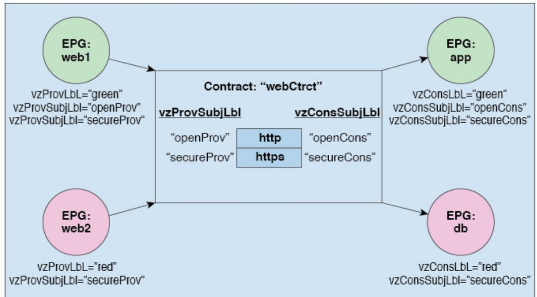
たとえば、TCP ポート 80 とポート 8080 を指定する HTTP と呼ばれるフィルタと、TCP ポート 443 を指定する HTTPS と呼ばれる別のフィルタを定義できます。その後、2セットの情報カテゴリを持つ webCtrct と呼ばれるコントラクトを作成できます。openProv と openCons are が HTTP フィルタが含まれる情報カテゴリです。secureProv と secureCons は HTTPS フィルタが含まれ
