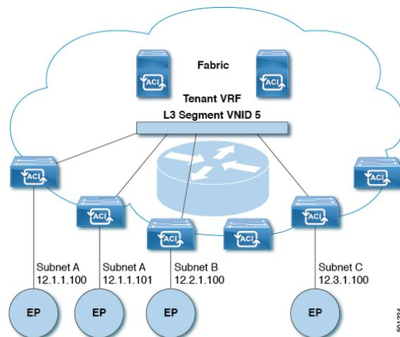
ACIはファブリックの各テナントVRFに単一のL3 VNIDを割り当てます。ACIは、L3 VNIDに従ってファブリック全体にトラフィックを転送します。出力リーフスイッチでは、ACIによってL3 VNIDからのパケットが出力サブネットのVNIDにルーティングされます。
