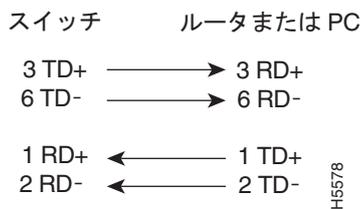
図 B-6 10/100 ポート用の 2 対のツイストペアクロスケーブルの配線
