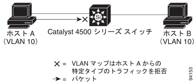
図 47-2 VLAN マップによるトラフィックの制御
