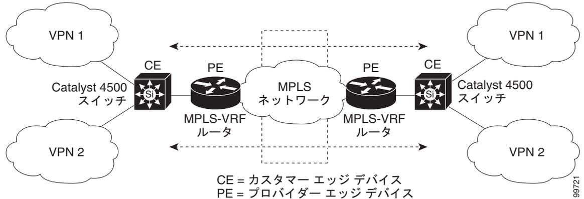
次に、図 29-1 に表示される VRF-Lite CE 対応ネットワークの packets 転送プロセスを示します。
