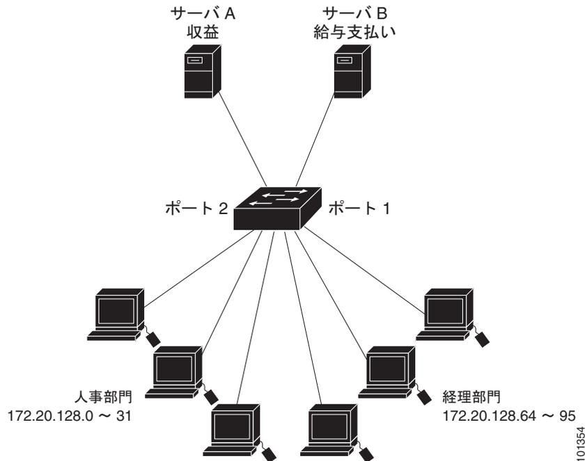
次に、標準 ACL を使用してポートからサーバ B に着信するトラフィックをフィルタリングし、経理部の送信元アドレス 172.20.128.64 ~ 172.20.128.95 から送信されるトラフィックのみを許可する例を示します。この ACL は、指定された送信元アドレスを持つルーテッドポート 1 から送信されるトラフィックに適用されます。
