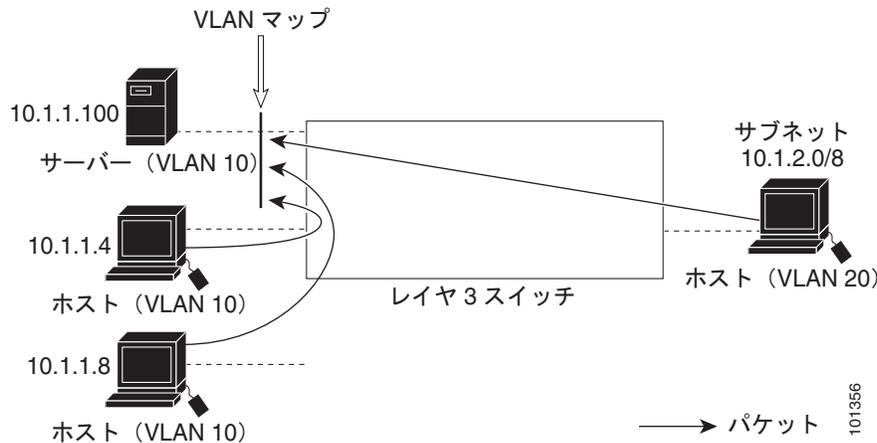
次に、サブネット 10.1.2.0/8 内のホスト、ホスト 10.1.1.4、およびホスト 10.1.1.8 のアクセスを拒否し、その他の IP トラフィックを許可する VLAN マップ SERVER1\_ACL を作成して、別の VLAN 内のサーバへのアクセスを拒否する例を示します。最後のステップでは、マップ SERVER1 を VLAN 10 に適用します。
