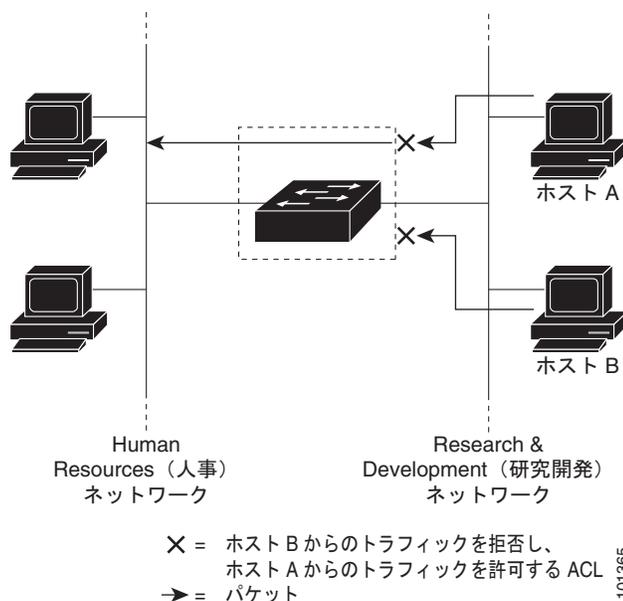
ポート ACL をトランク ポートに適用すると、そのトランク ポートにあるすべての VLAN で ACL によるトラフィックのフィルタリングが実行されます。音声 VLAN のあるポートにポート ACL を適用すると、データ VLAN と音声 VLAN の両方でその ACL によるトラフィックのフィルタリングが実行されます。
