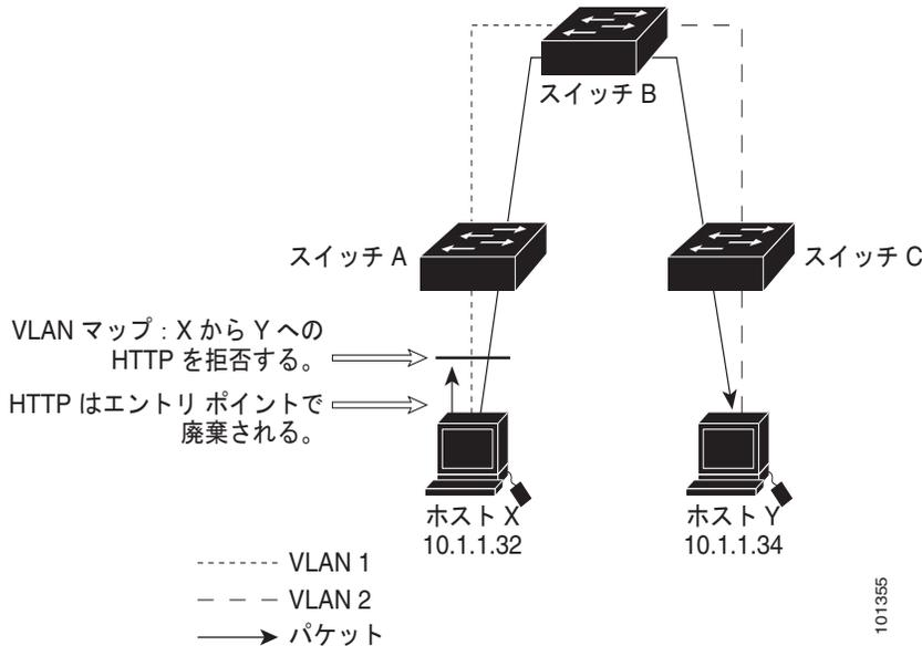
HTTP トラフィックをホスト X からホスト Y へスイッチングしない場合は、ホスト X (IP アドレス 10.1.1.32) からホスト Y (IP アドレス 10.1.1.34) に向かうすべての HTTP トラフィックがスイッチ A で廃棄され、スイッチ B にブリッジングされないように、スイッチ A の VLAN マップを設定できます。
