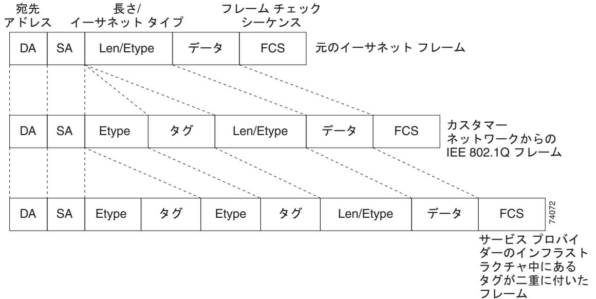
パケットがサービス プロバイダー 出力スイッチのトランク ポートに入ると、スイッチがパケットを内部処理する間に外部タグは再び外されます。ただし、パケットがエッジ スイッチのトンネル ポートからカスタマー ネットワークに送信される時、メトロ タグは追加されません。パケットは通常の IEEE 802.1Q タグ フレームとして送信され、カスタマー ネットワーク内で元の VLAN 番号は保護されます。
