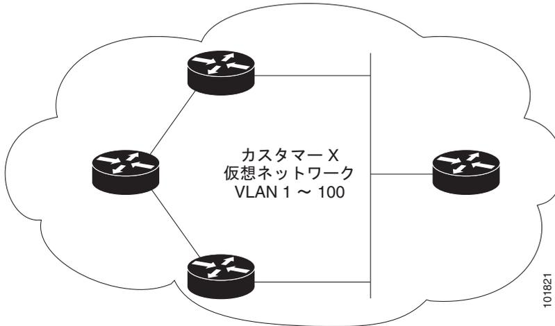
サービスプロバイダー ネットワークでは、レイヤ 2 プロトコル トンネリングを使用し、ポイントツープイント ネットワーク トポロジをエミュレートして、EtherChannel の作成を向上させることができます。サービスプロバイダー スイッチでプロトコル トンネリング (PAgP または LACP) をイネーブルにすると、リモート カスタマー スイッチでは PDU が受信され、EtherChannel の自動作成をネゴシエーションできるようになります。
