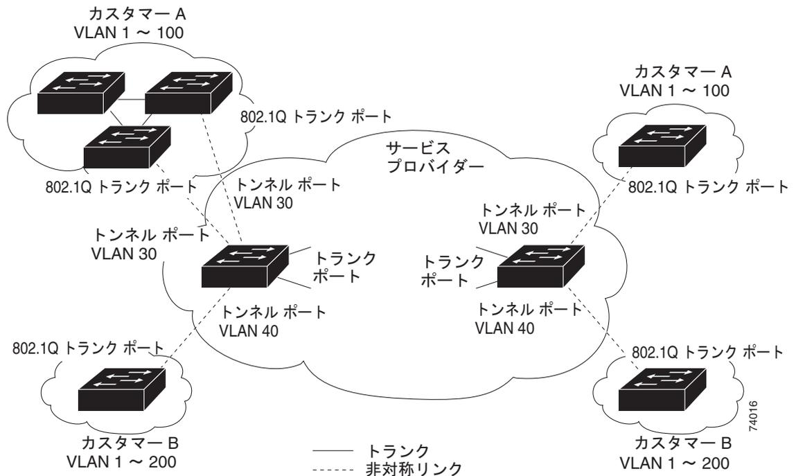
顧客のトランクポートからサービスプロバイダーのエッジスイッチのトンネルポートに発信されるパケットには、通常、適切な VLAN ID とともに IEEE 802.1Q タグが付いています。タグはスイッチ内でそのまま残り、タグ付きパケットがトランクポートからサービスプロバイダー ネットワークに発信されると、顧客に固有の VLAN ID を含む IEEE 802.1Q タグの別のレイヤ（メトロタグと呼ばれる）でカプセル化されます。顧客の元の IEEE 802.1Q タグは、カプセル化されたパケット内で保護されます。このため、サービスプロバイダー ネットワークに入るパケットには、顧客のアクセス VLAN ID を含む外部（メトロ）タグ、および着信トラフィックのものである内部 VLAN ID という、二重のタグが付いています。
