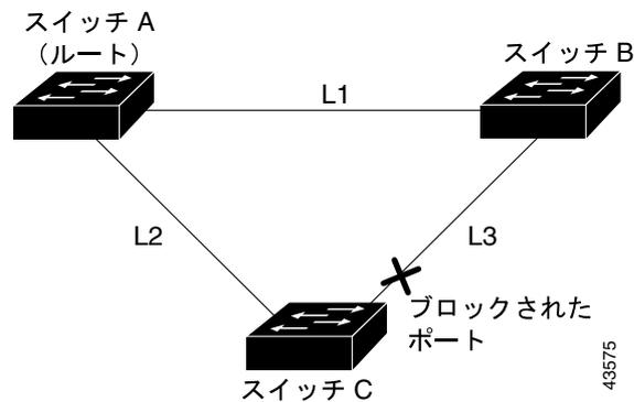
スイッチ C がルート ポートで、現在アクティブ リンクである L2 のリンク障害 (直接リンク障害) を検出すると、UplinkFast がスイッチ C でブロックされていたインターフェイスのブロックを解除し、リスニング ステートおよびフォワーディング ステートを経由せずに、フォワーディング ステートに移行させます。図 17-4 を参照してください。この切り替えに必要な時間は、約 1 ~ 5 秒です。
