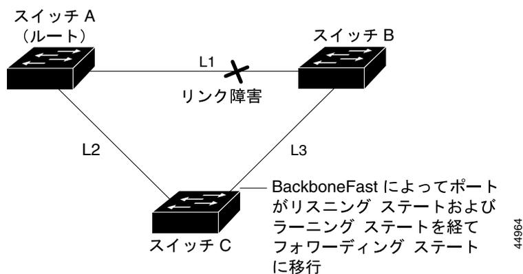
図 17-7 のように、新しいスイッチがメディア共有型トポロジーに組み込まれた場合、認識された指定スイッチ（スイッチ B）から下位 BPDU が届いていないので、BackboneFast はアクティブになりません。新しいスイッチは、自身がルートスイッチであることを伝える下位 BPDU の送信を開始します。ただし、他のスイッチはこれらの下位 BPDU を無視し、新しいスイッチはスイッチ B がルートスイッチであるスイッチ A への指定スイッチであることを学習します。
