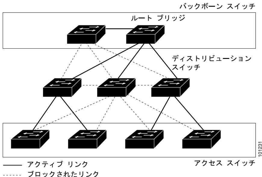
スイッチの接続が切断されると、スイッチはスパニングツリーが新しいルート ポートを選択すると同時に代替パスの使用を開始します。リンクやスイッチに障害が発生した場合、またはスパニングツリーが再設定された場合は、**spanning-tree uplinkfast** グローバル コンフィギュレーション コマンドを使用して UplinkFast をイネーブルにすることにより、新しいルート ポートを短時間で選択できます。ルート ポートは、通常のスパニングツリー手順とは異なり、リスニング ステートおよびラーニング ステートを經由せず、ただちにフォワーディング ステートに移行します。
