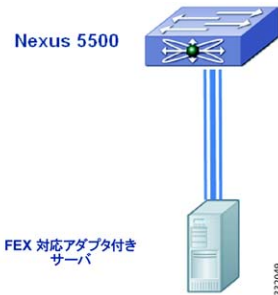
図 1-2 Cisco Nexus 5500 シリーズ デバイスに接続されている Adapter-FEX 対応サーバ
