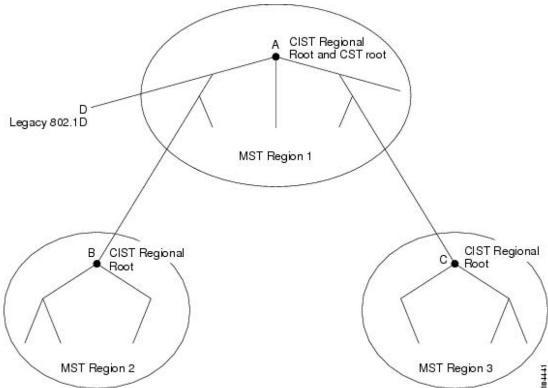
BPDUを送受信するのはCSTインスタンスのみです。MSTIは、そのスパンニングツリー情報をBPDUに(Mレコードとして)追加し、隣接スイッチと相互作用して、最終的なスパンニングツリートポロジを計算します。このため、BPDUの送信に関連するスパンニングツリーパラメータ(helloタイム、転送時間、最大エージングタイム、最大ホップカウントなど)は、CSTインスタンスにのみ設定されますが、すべてのMSTIに影響します。スパンニングツリートポロジに関連するパラメータ(スイッチプライオリティ、ポートVLANコスト、ポートVLANプライオリティなど)は、CSTインスタンスとMSTIの両方に設定できます。
