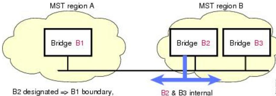
境界では、MST ポートのロールは問題ではなく、そのステータスは強制的に IST ポートステータスと同じに設定されます。境界フラグがポートに対してオンに設定されている場合、MST ポートのロールの選択処理では、ポートのロールが境界に割り当てられ、同じステータスが IST ポートのステータスとして割り当てられます。境界にある IST ポートでは、バックアップポートのロール以外のすべてのポートのロールを引き継ぐことができます。
