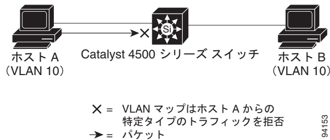
図 39-2 VLAN マップによるトラフィックの制御
