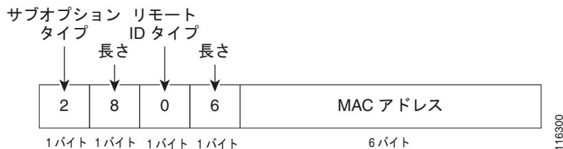
図 37-3 に、ユーザ設定のリモート ID および回線 ID サブオプションのパケット フォーマットを示します。DHCP スヌーピングがグローバルにイネーブルで **ip dhcp snooping information option format remote-id** グローバル コンフィギュレーション コマンドおよび **ip dhcp snooping vlan information option format-type circuit-id string** インターフェイス コンフィギュレーション コマンドが入力されると、スイッチにより、パケット フォーマットが使用されます。
